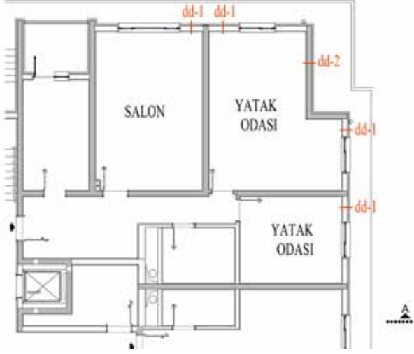
Şekil B.5. Plan üzerinde gösterim örneği: Zemin Kat Planı - Dış Yapı Elemanları Kodları
