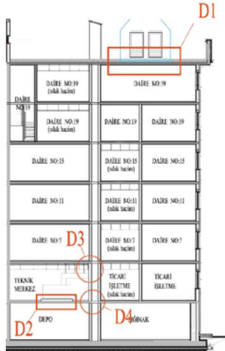
Şekil B.12 Detay Numarası Gösterimi Örneği : A-A Kesiti
